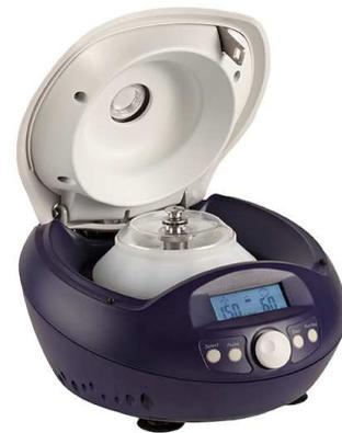
Bei der CD-2012 handelt es sich um eine kleine Arbeitsplatz-Zentrifuge mit hoher Leistungsfähigkeit. Durch das beleuchtete Display und die übersichtliche Anordnung der Bedienelemente erlaubt die Zentrifuge eine intuitive Bedienung durch den Bediener. Selbstverständlich entspricht die Ausstattung den höchsten Sicherheitsstandards.
